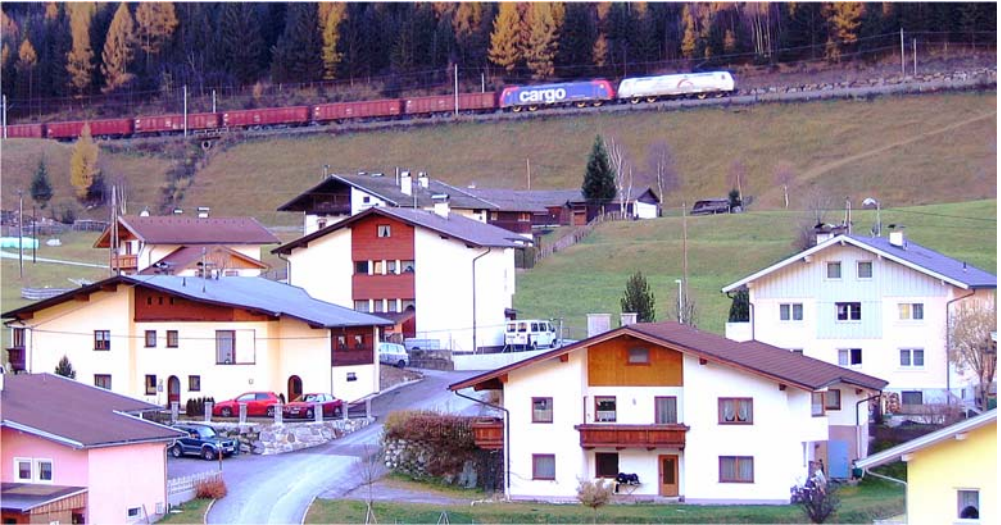
Fig. 4 Tre motrici elettriche, due traenti e una spingente, sono necessarie per movimentare i vagoni di questo treno merci sulla ripida salita verso il passo del Brennero/Brennerpass in prossimità dell'abitato di St. Jodok/Tirol.
