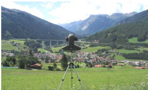
Fig. 13 La testa artificiale dotata di microfoni registra l'effetto anfiteatro da una "loggia d'onore" sul lato orientale della Wipptal con il viadotto dell'autostrada verso il Brennero/Brenner sullo sfondo (in prossimità di Steinach/Austria).
