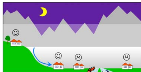
Fig. 11b Durante la notte le emissioni sono confinate dalle inversioni sul fondovalle. Siti prossimi alle pendici dei pendii beneficiano dei venti di pendio (blu). Gli altopiani spesso sono al di sopra degli strati di inversione e restano nello strato residuo del giorno precedente.
