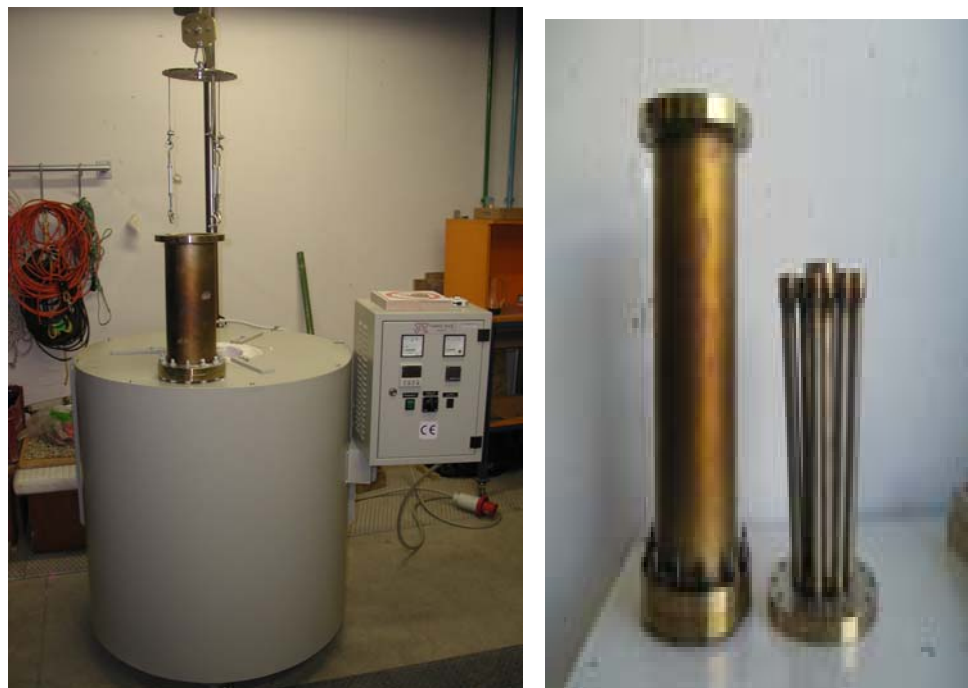
Figura 12. Apparato sperimentale: forno a pozzo (a sinistra) e reattore di gassificazione (a destra)
