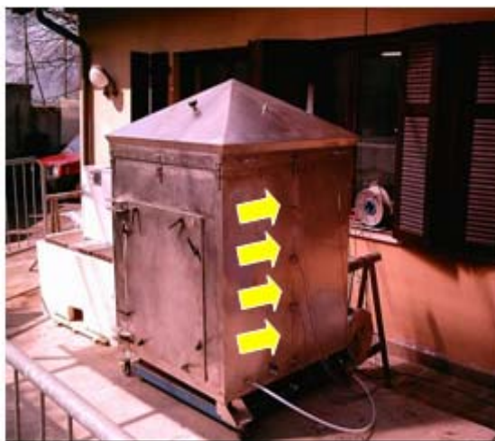
Figura 1. Vista frontale del reattore biologico poggiato sulla piattaforma di pesatura
