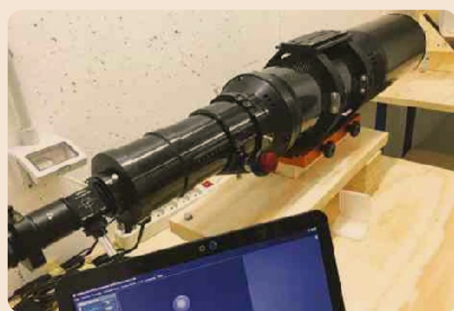
Banco ottico per eseguire la collimazione ed i test sui telescopi
